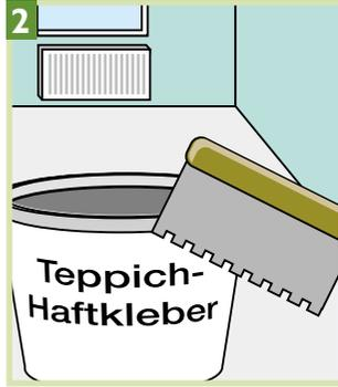
1 Vollflächig aufgebrachte Teppichfixierung schützt Bodenbeläge mit Glattschaumrücken vor Verwerfungen und dem Auswalken. Der Belag wird zuerst grob zugeschnitten, im Raum ausgelegt und genau eingepaßt. Nun den Teppichboden halbseitig zurückschlagen, die Fixierung nach Anleitung auftragen und den Belag wieder auslegen und festdrücken. Genauso mit der zweiten Hälfte verfahren.
