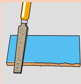
Raue, unschöne Bruchkanten kann man leicht mit einer Hartmetallfeile begradigen. Den letzten Schliff erhält die Kante mit normalem Schleifpapier.
