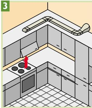
1 Die Entlüftungsanlage im sanitären Bereich kann auch zur Lüftung des Wohnbereiches herangezogen werden. Führen Sie den Wohnräumen Frischluft zu, indem diese über Öffnungen an den Türen oder Wänden den Räumen mit schlechterer Luft zuströmen
